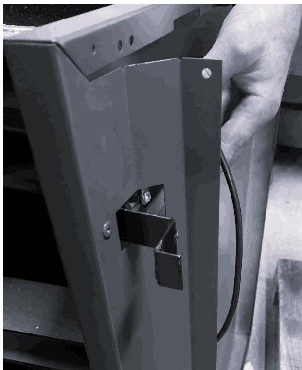
Obr. 15 - 17 Montáž koncového spínače
